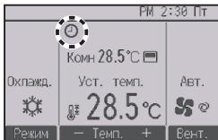
будет отображаться на Основном экране в режиме «Полный», когда включена функция «Таймер ВКЛ/ВЫКЛ».
