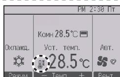
будет отображаться на Основном экране в режиме «Полный», если температурный диапазон ограничен.
