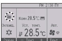
Когда отобразится на Основном экране, настроенном на отображение в режиме «Полный», то система находится под централизованным управлением и значение фильтра не может быть сброшено.
